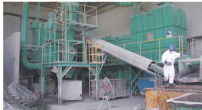
静岡県 浜松市 Y社 建設廃材選別装置
